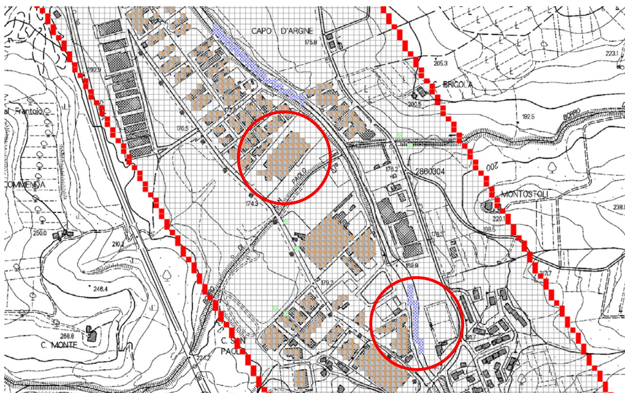
Figura 27 - Modello bidimensionale implementato con il software FLO-2D - Individuazione outflow e reduction factors.
