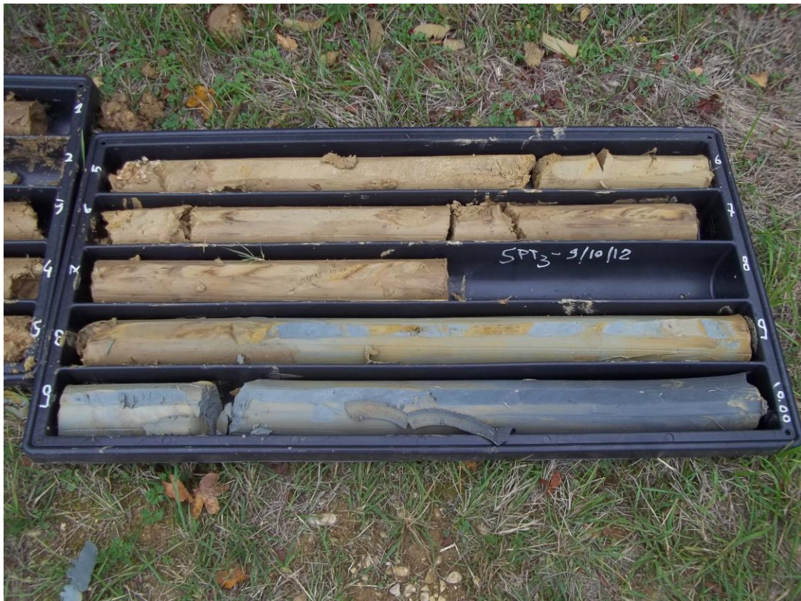
Foto n° 10 – Stratigrafia da “- 5 m/pc a – 10 m/pc”
