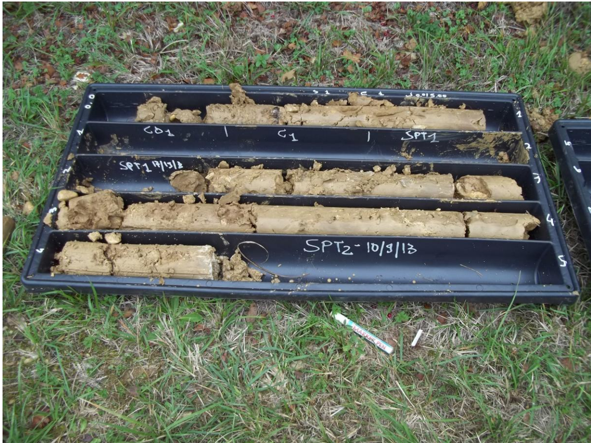
Foto n° 9 – Stratigrafia da “pc a – 5 m/pc”
